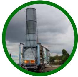
**Mobile Brennkammer mit einer Verbrennungsleistung von 20 MW**
