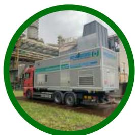
**Mobile Brennkammer mit einer Verbrennungsleistung von 3 MW**
