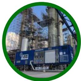
**Mobile Brennkammer mit einer Verbrennungsleistung von 4 MW**
