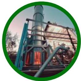
**Mobile Brennkammer mit einer Verbrennungsleistung von 5 MW**
